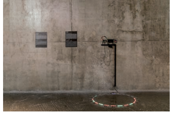
Şekil 2: Sistemin BangPrix 2018'de sergilenen hali. Elektrik devresi duvara asılmıştır. Bireyleri temsil eden butonlar ortadaki siyah kutunun üzerindedir. Kutunun sağında ve solunda sırasıyla Arduino Uno ve Raspberry Pi2 vardır. Pleksi çember ise yere yerleştirilmiştir. Fotoğraf: BangPrix 2018.
